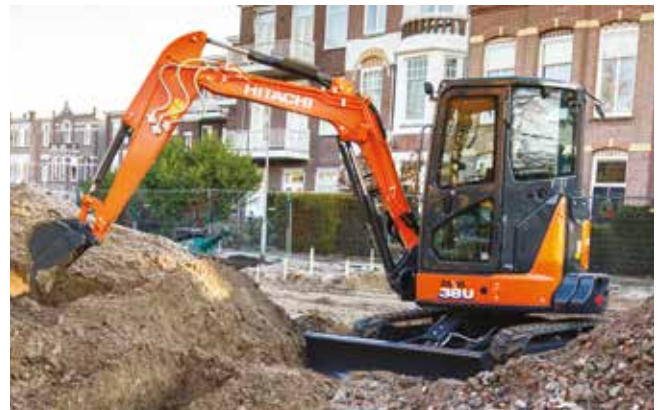
Dank des kleinen Heckschwenkradius ist der ZX38U-6 ideal für Arbeit auf engem Raum.
