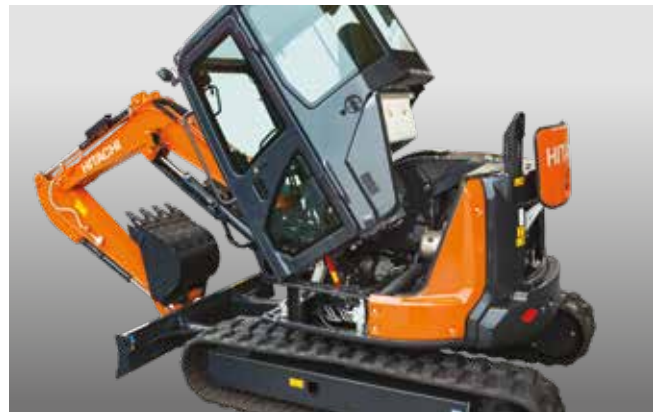
Die kippbare Kabine ermöglicht einen einfachen Zugang zum Motor und zum Steuerventil für eine schnelle Wartung.
